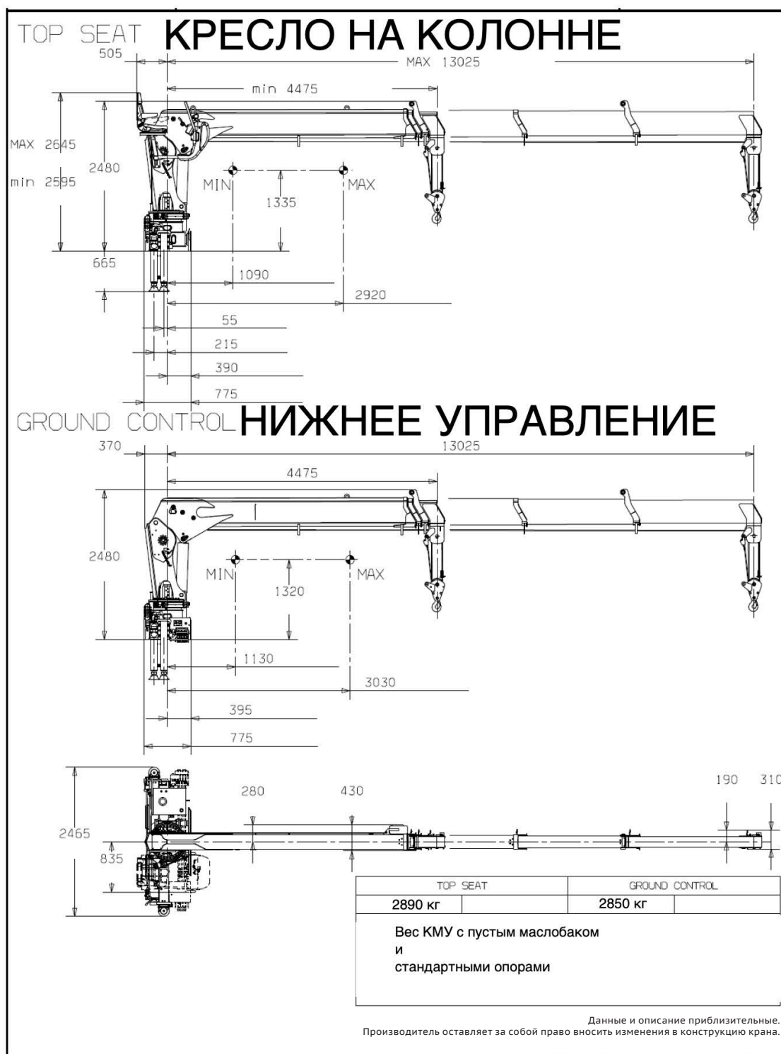
Рисунок 3 Геометрические параметры и центр тяжести КМУ (п. 2.4.1)
